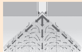
Figura 10 – Profilo del flusso d'aria immessa con diffusori lineari ad alta induzione
