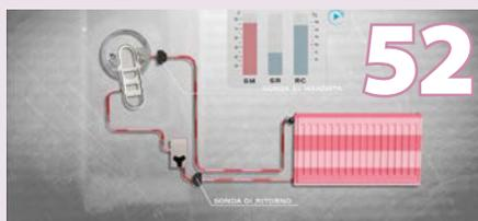
**52****INNOVAZIONE DI PRODOTTO****Sistema ibrido compatto con recupero termodinamico dai fumi di combustione**
