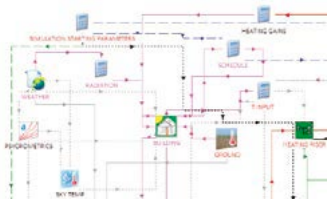
Figura 2 – Estratto del modello di simulazione dinamica in TRNSYS
