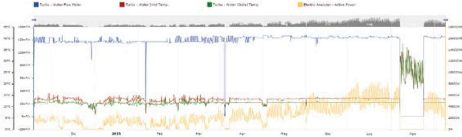
Figura 9 – Diagramma della portata (blu) e della temperatura dell'acqua entrante (rosso) e uscente (verde). In giallo sono rappresentati i consumi di energia elettrica.
