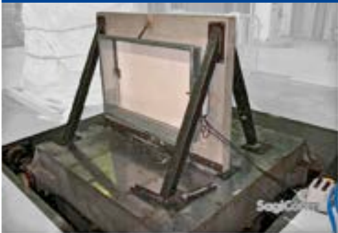
Figura 4 – Serranda tagliafuoco SagiCofim HTE400 (1200 x 800) sulla tavola sismica
