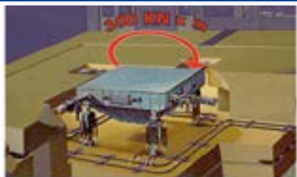
Figura 3 – Prova sismica con tavola vibrante. [2]
