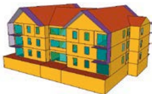
Figura 7 – Modello geometrico tridimensionale in "Trnsys3d" per il CS2.1
