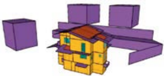
Figura 5 – Modello geometrico tridimensionale in “Trnsys3d” del CS1
