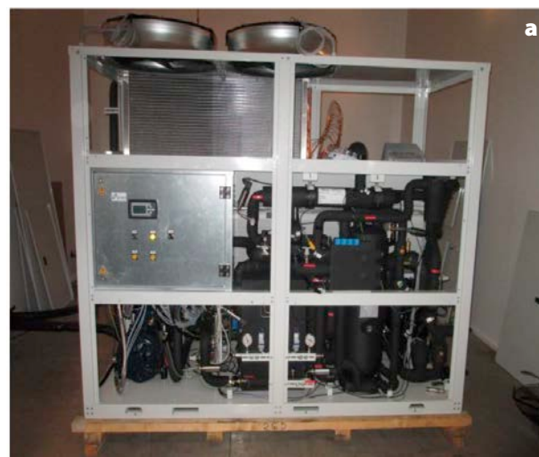
Figura 1 – (a) Prototipo di pompa di calore con sistema multi eietttore installato in camera climatica. (b) Gruppo multi-eietttore
