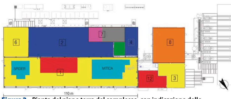
**Figura 2** – Pianta del piano terra del complesso, con indicazione delle tipologie dei terminali. Giallo: aria primaria e aerotermi caldo/freddo; blu: solo aspirazione; magenta: impianto VRF; verde: condizionamento di precisione; azzurro: aria primaria e ventilazione maggiorata; grigio: ventilconvettori; rosso: pannelli radianti (edificio 1) o radiatori (edificio 12)
