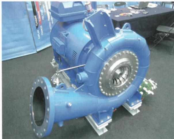
Figura 5 - Nell'immagine, turbina Francis della Zeco srl (P=90 kW, H=41÷80 m, Q=130÷160 l/s)
