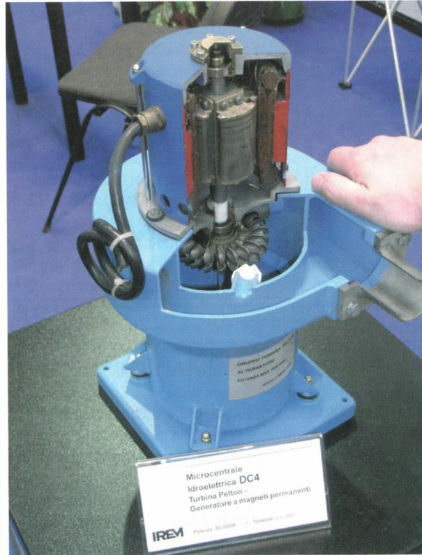
**Figura 3 - Micro-turbine Pelton: modello da 50-500 W della Irem spa, accoppiato ad un generatore in corrente continua a magneti permanenti a 24 V**
