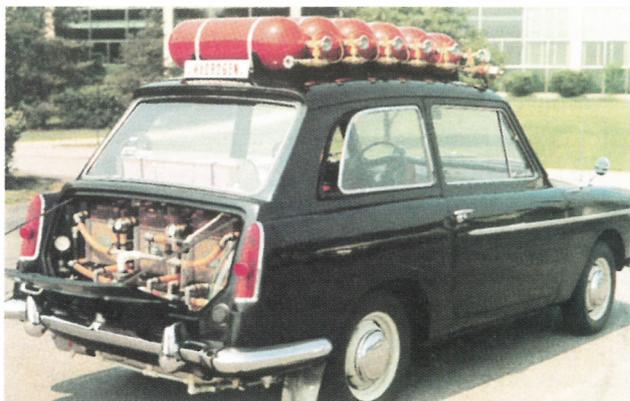
*Figura 3 - Il primo prototipo di automobile a fuel cells: Austin A40 Sedan del 1966*
