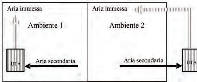
Fig. 3.4 - Unità periferiche di trattamento dell'aria o dispositivi terminali che trattano aria secondaria prelevata da ambienti poco contaminati, ma che non aggiungono aria esterna. Le linee guida si applicano alla regione colorata in grigio. L'aria salubre interna, nella zona occupata, è quella circolante nella regione tratteggiata verticalmente in grigio.
